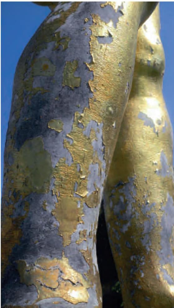
Abb. 44. Statue aus Bleiguss mit abgeplatzter Blattvergoldung: abblätternde Farb- und Goldschichten durch ungenügende Untergrundvorbereitung (unzureichende Entsalzung) und fehlende Haftgrundierung.
