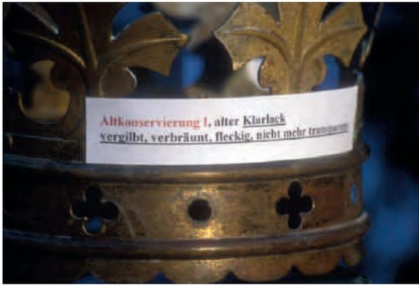
Abb. 20. Messingteil mit typischer Oberflächenalterung in Verbindung mit transparenten organischen Schutzschichten.
