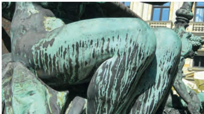
*Abb. 18. Übliche grün-schwarze Oberflächentextur einer freibewitterten Bronze mit partiellen Korrosionsverlusten.*
