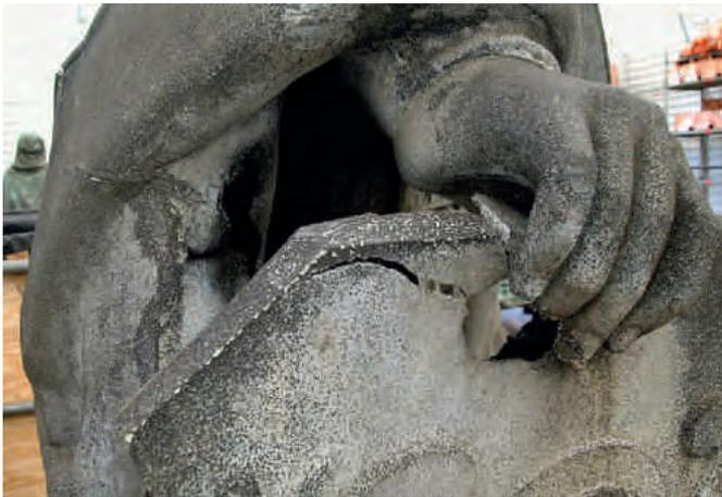
*Abb. 9. Freigelegte Reste einer galvanischen Verkupferung mit typischen Lochfraßstellen.*
